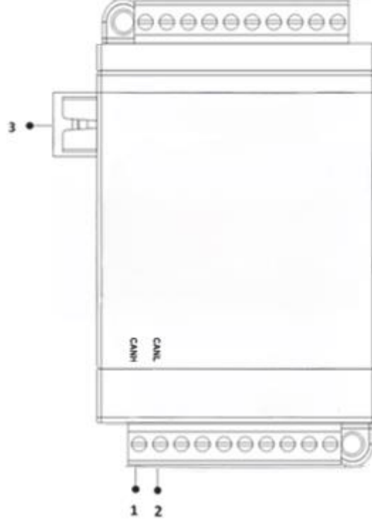
Şekil 28 GDY Kartı Klemens ve Fiziksel Arayüzü
